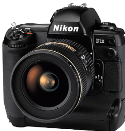
Obr. 8 Digitální fotoaparát Nikon D1x (CCD senzor 5,33 megapixelů)
